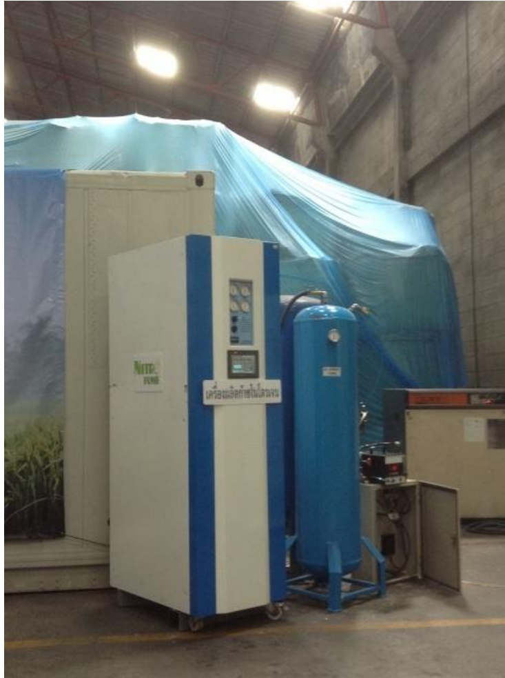
เครื่องผลิตก๊าซไนโตรเจนสำหรับรมข้าวเพื่อให้มอดและด้วงงวงข้าวขาดอากาศหายใจ
